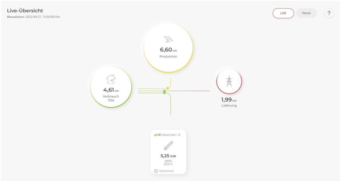
Die Kachel zeigt die aktuelle Leistungsaufnahme des Heizstabs sowie die Temperatur des integrierten Temperaturfühlers.
