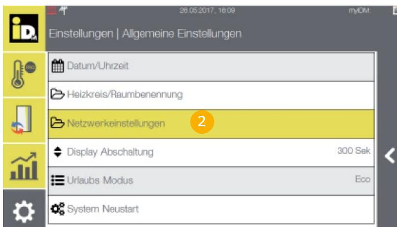
3. Menü DHCP auf „Nein“ setzen, um der Wärmepumpe eine statische IP-Adresse zuweisen zu können.
