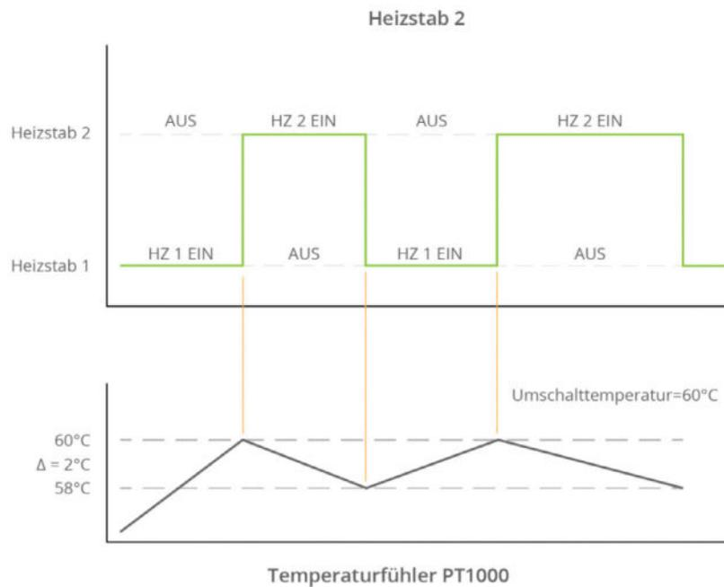
Option 2: 2 Heizstäbe in einem Boiler/Puffer.
