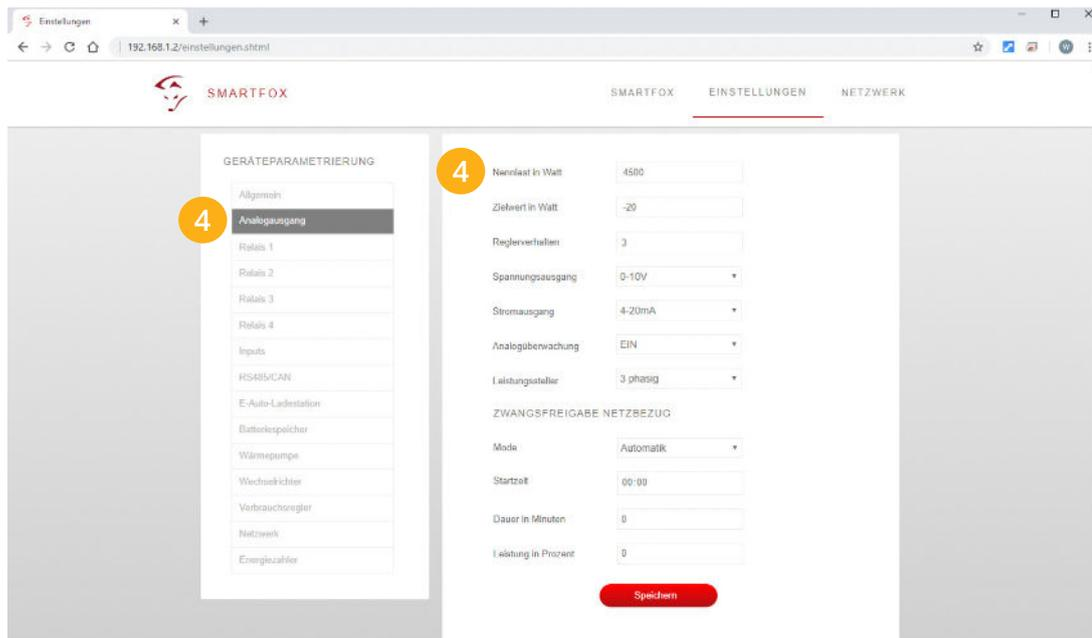
4. Unter „Analogausgang“ die Nennleistung des Heizstab 1 (Boiler) einstellen. Im Beispiel sind dies **4500W**. Die restlichen Werte im Menüpunkt „Analogausgang“ können für die meisten Anwendungen aus dem Screenshot übernommen werden. Genauere Infos zu einzelnen Parametern entnehmen Sie der Bedienungsanleitung Ihres SMARTFOX.
