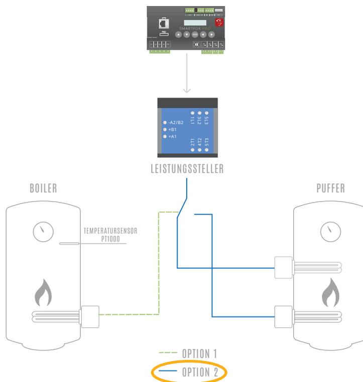
Der obere Heizstab wird priorisiert angesteuert, um schnell heißes Wasser im Abnahmebereich bereit stellen zu können. Der Temperaturfühler (PT1000) wird im oberen Bereich des Boilers/Puffers installiert. Ist die Umschalttemperatur erreicht, wird auf den unteren Heizstab umgeschaltet und der Boiler/Puffer von unten durchgeladen.
