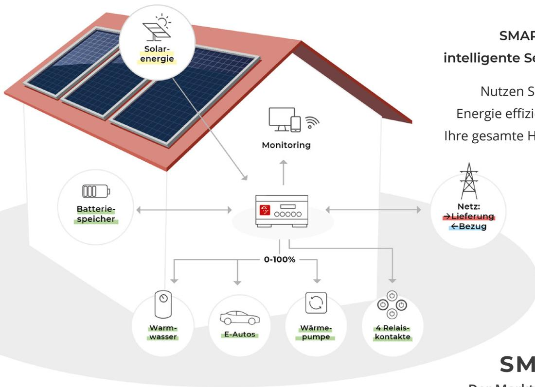
SMARTFOX ermöglicht intelligente Sektorenkopplung.
