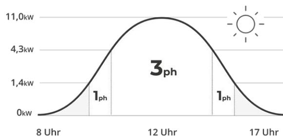
SMARTFOX Pro wählt automatisch den besten Betriebspunkt, dadurch kann auch bei „geringer Energieausbeute der PV-Anlage“, wie z.B. bei Schlechtwetter, mit reinem Überschuss geladen werden. Bei wenig Leistung kann die Ladung 1-phasig bereits ab 1,4kW gestartet werden. Steigt die überschüssige Energie, wechselt SMARTFOX automatisch in die 3-phasige Ladung und kann nun bis 11kW stufenlos ansteuern.
