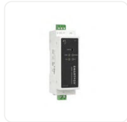
SMARTFOX RS485 / Ethernet Converter für Pro Charger
