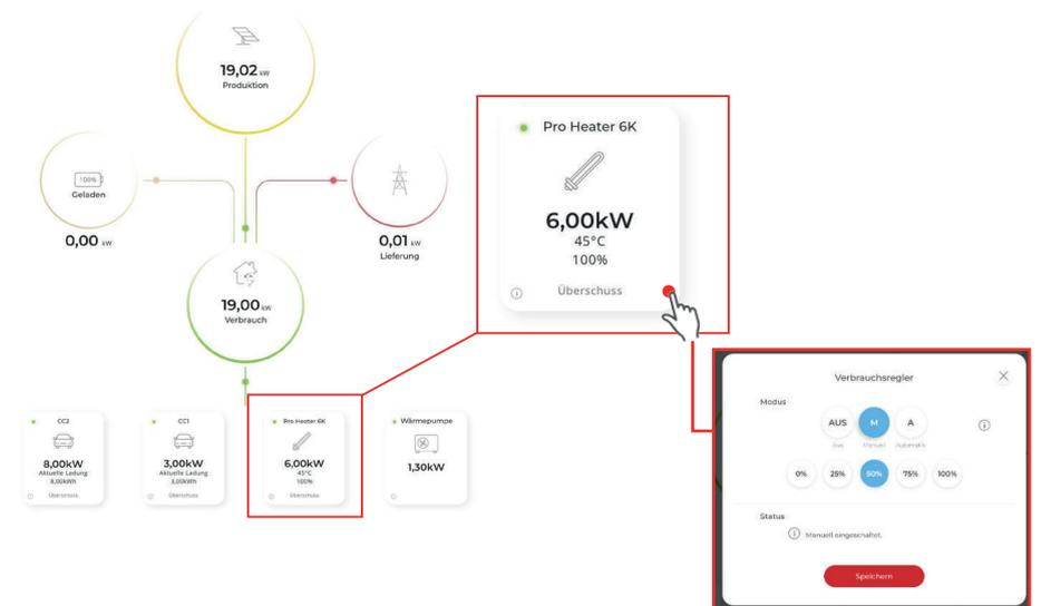
**Modus AUS (Abgeschaltet):** Der Heizstab ist gesperrt und wird nicht eingeschaltet.
