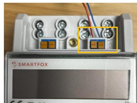
Für den Anschluss wird ein verdrehtes Adernpaar (z.B. CAT6) verwendet. Ein Draht (z.B. rot) wird vom **RS485+** Kontakt des SMARTFOX mit **Pin 21** (RS485 A) des SMARTFOX Energy Meters verbunden. Der zweite Draht (z.B. blau) vom **RS485-** Kontakt des SMARTFOX mit **Pin 20** (RS485B) des Energy Meters.
