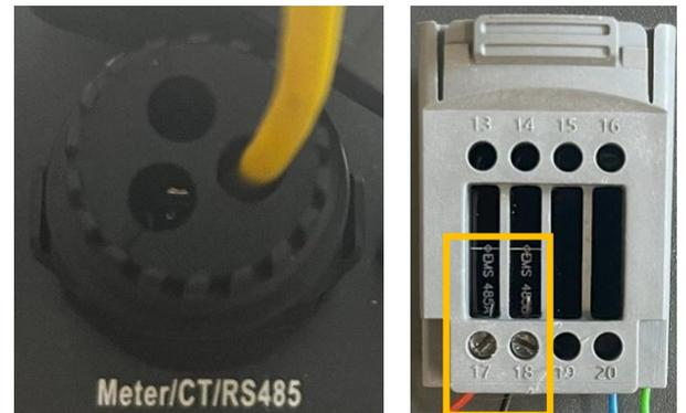
Für den Anschluss wird ein verdrehtes Adernpaar (z.B. CAT6) verwendet.
