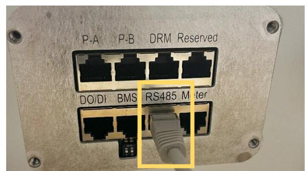
Für den Anschluss am SMARTFOX wird der Draht von **Pin 5** (z.B. T-568B = weiß/blau) mit dem **RS485+** Kontakt verbunden. Der Draht von **Pin 4** (z.B. T-568B = blau) wird mit dem **RS485-** Kontakt des SMARTFOX verbunden.
