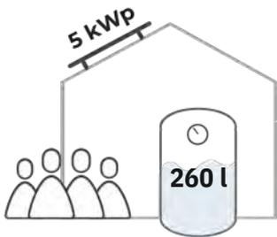
**Bsp.:** Wird bei einem Vierpersonenhaushalt, welcher ca. 260 l Warmwasser pro Tag benötigt, das SMARTFOX System **lediglich zur Warmwasserbereitung** genutzt, erreicht man bereits einen **Eigenverbrauch von bis zu 80%**.
